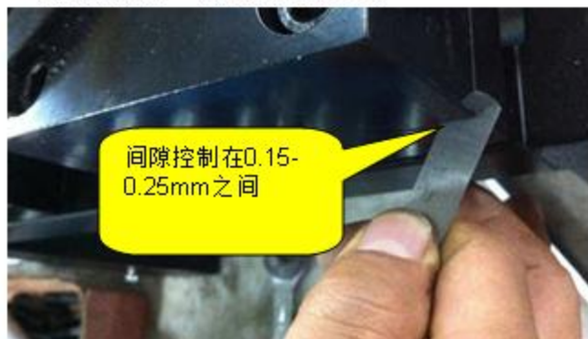
步骤3: 用塞尺检查铁芯和衔铁之间的间隙:0.15~0.25mm
