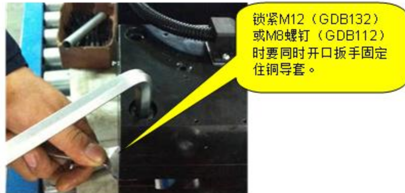
步骤5: 最后锁紧M12 (GDB132) 或者M8螺钉 (GDB112)
