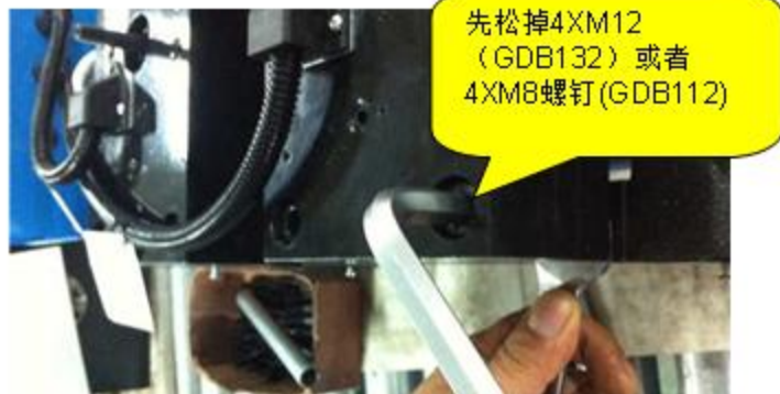
步骤1: 制动器断电状态下, 拧松M12 (GDB132) 或者M8螺钉 (GDB112)
